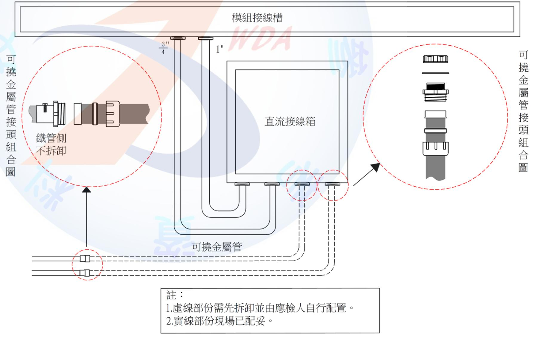
圖1-3 直流接線箱配管圖(獨立型)
